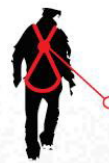
Queda FATOR 2 ponto de ancoragem situado a baixo da conexão dorsal do arnês
